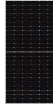
Modulo Fotovoltaico Si Mono Bifacciale Fabbricazione: Sun-Earth Modello: DXMB 72HSG 685 Wp Dimensioni (LxHxP): 1.134x2.278x30mm Peso: 32 Kg
